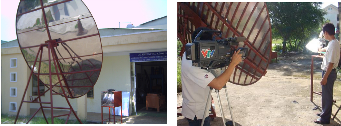
Hình 4. Hệ thống bếp nấu có thể định vị theo hướng mặt trời trong 1 ngày
